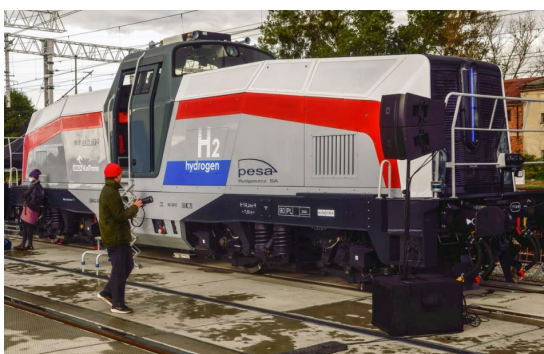
1. kép: Kísérleti, hidrogénhajtású mozdony
