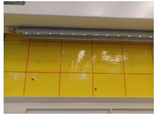
2. ábra Energiatakarékos és szóródásmentes rovarcsapda
