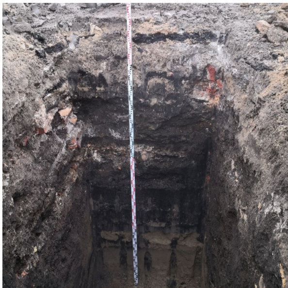
5. ábra talajszelvény egy szennyezett anyaggal történő feltöltés esetén
