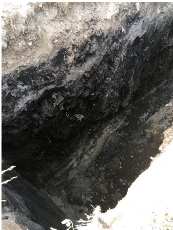
6. ábra talajszelvény egy szennyezett anyaggal történő feltöltés esetén
