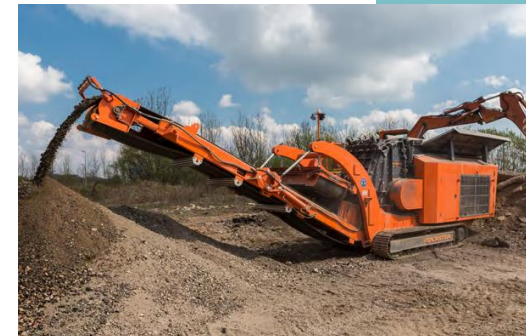
Újrahasznosítás és újrafelhasználás mobil zúzóval
